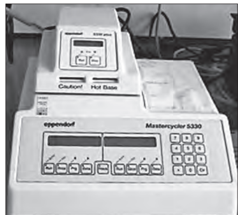
Рис. 3. Типовий ампліфікатор для ПЛР
