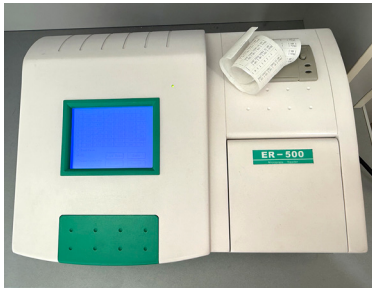
Рис. 7. Мікропланшетний фотометр ER-500 Microplate Reader (SINNOWA) в роботі.
